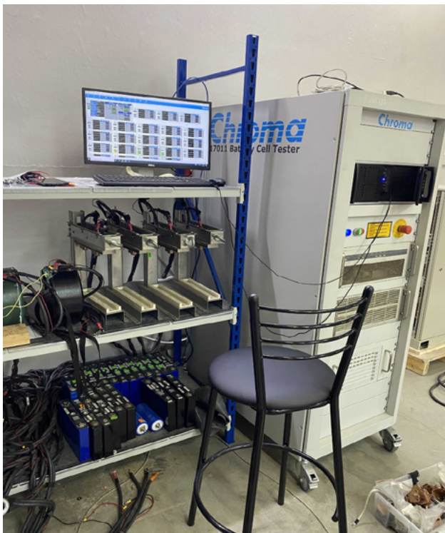
Рис. 6. Испытательный стенд Chroma 17011 Battery Cell Test
