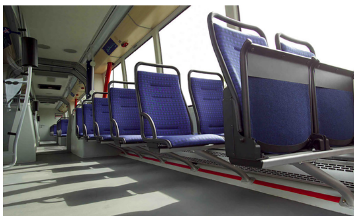
Рис. 5. Внутренний интерьер транспортного средства Phileas, имеется пространство для размещения багажа под сиденьями
