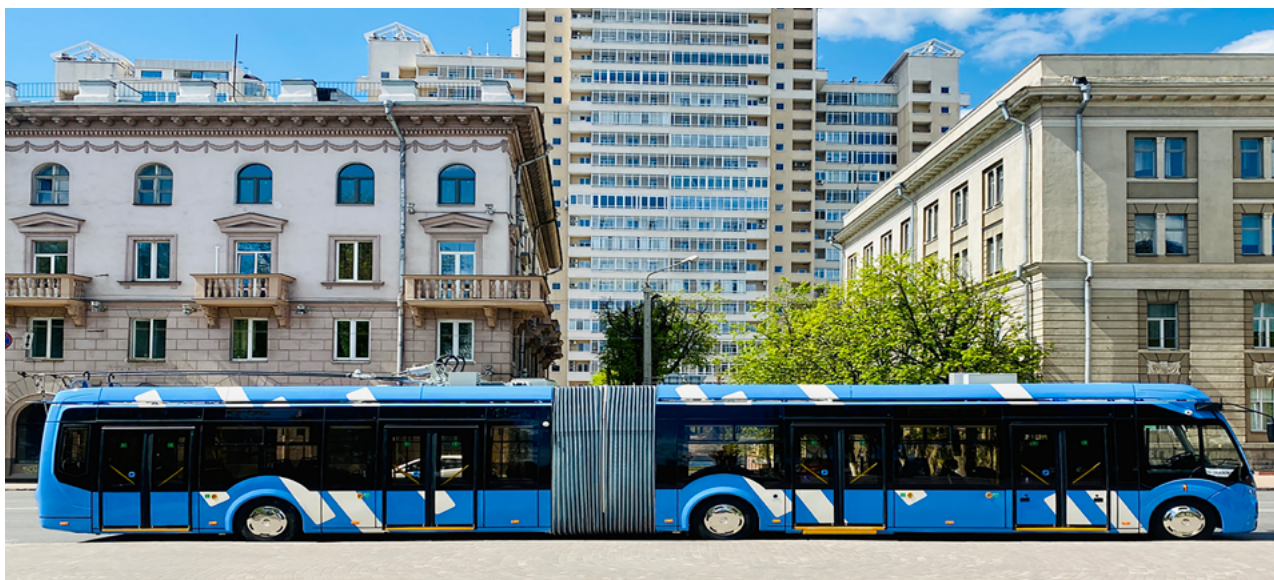
Рис. 4. Троллейбус модели 433.030 Vitovt Max II на базе Phileas в Санкт-Петербурге: длина (м) — 18,75; пассажироместность (чел.) — 160; мест для сидения — 42; максимальная масса (кг) — 28 000; мощность электродвигателя (кВт) — 180
