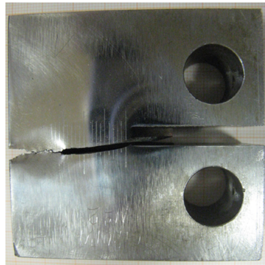
Рис. 2. Образец ВР с усталостной трещиной на боковой поверхности после окончательного разрушения
