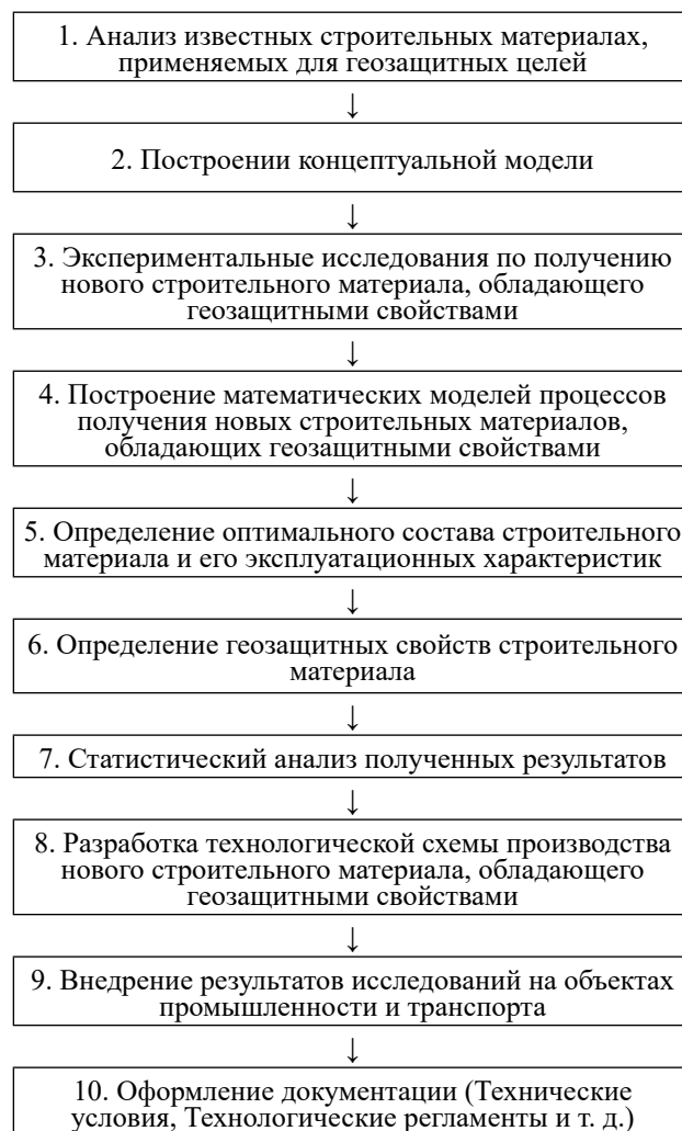
Рис. 5. Метод получения нового строительного материала, обладающего геозащитными свойствами
