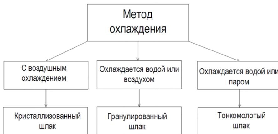
Рис. 4. Разделение шлака по способу охлаждения
