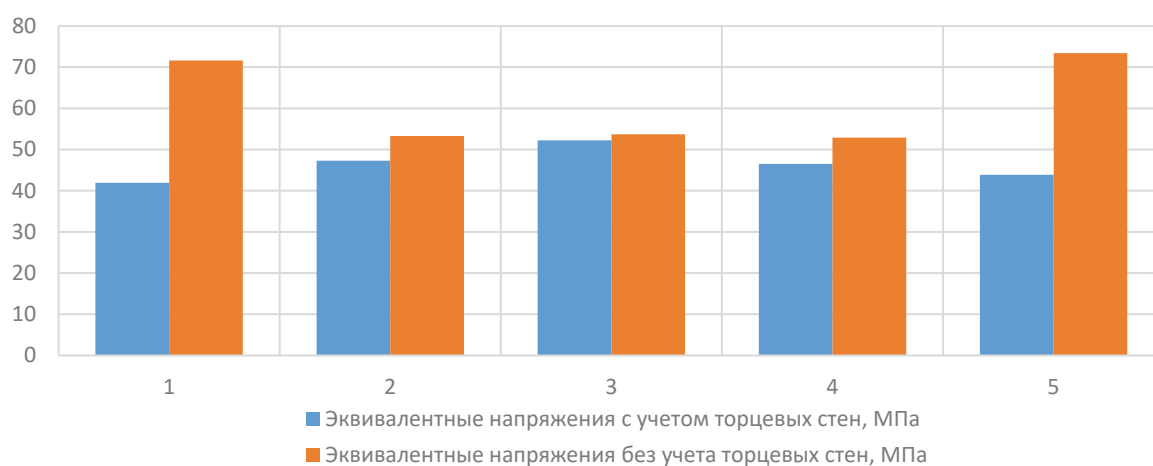
Рис. 3. Эквивалентные напряжения в стойках серийно выпускаемого полувагона: 1 — шкворневая стойка 1; 2 — промежуточная стойка 1; 3 — промежуточная стойка 2; 4 — промежуточная стойка 3; 5 — промежуточная стойка 4; 6 — шкворневая стойка 2
