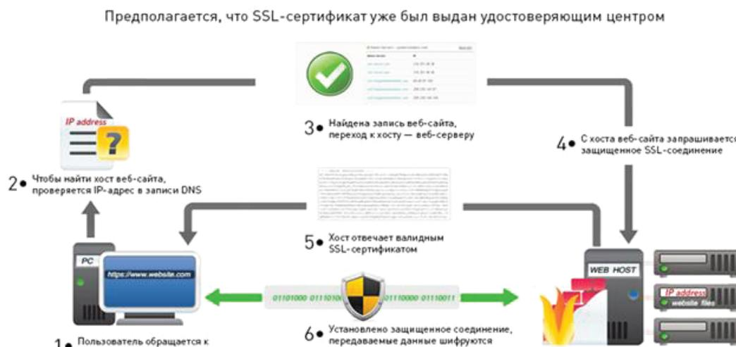
Рис. 2. Схема действия SSL
