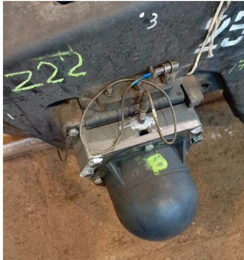
Рис. 3. УМДВ и акселерометры на буксовом узле при испытаниях (фото — А. А. Шамрай)
