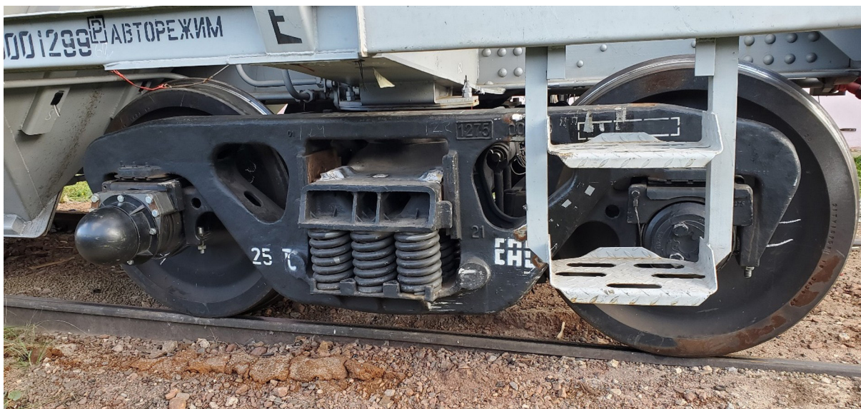
Рис. 1. Установленное УМДВ на буксовый узел тележки 18-9891 (фото — Д. Н. Солин)
