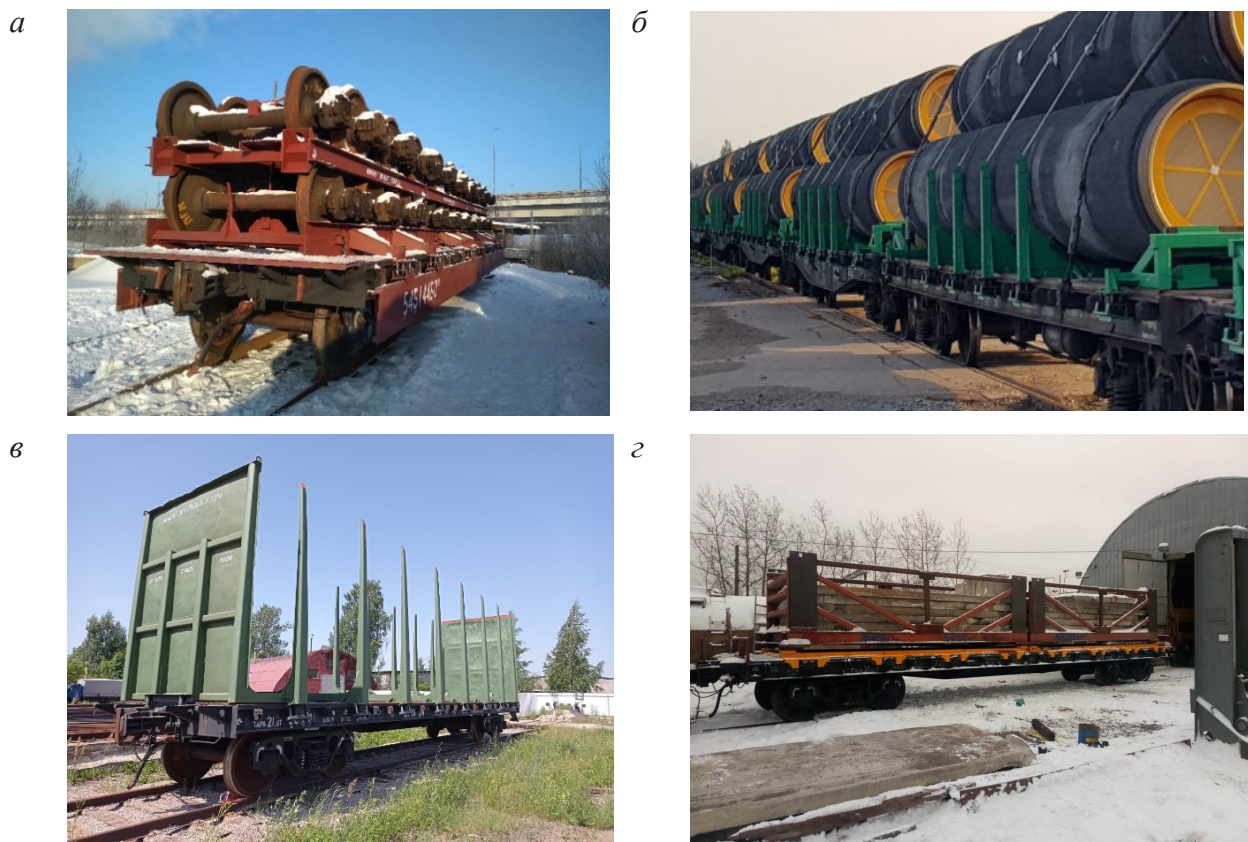
Рис. 1. Съемные многооборотные средства размещения и крепления грузов на универсальных вагонах-платформах разработки АО «НВЦ «Вагоны»: а — для перевозки колесных пар, АО «ВРК-2»; б — для перевозки труб, ООО «Транслокация»; в — для перевозки лесоматериалов, ООО «ВРК»; г — для перевозки контейнеров, АО «ПГК»
