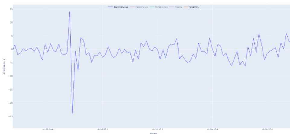
Рис. 17. УМДВ № 0020, грузеный вагон, скорость 60 км/ч, ползун на колесе с УМДВ № 0017
