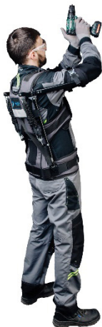
Рис. 3. Пример пассивного экзоскелета для поддержки рук Exorise
