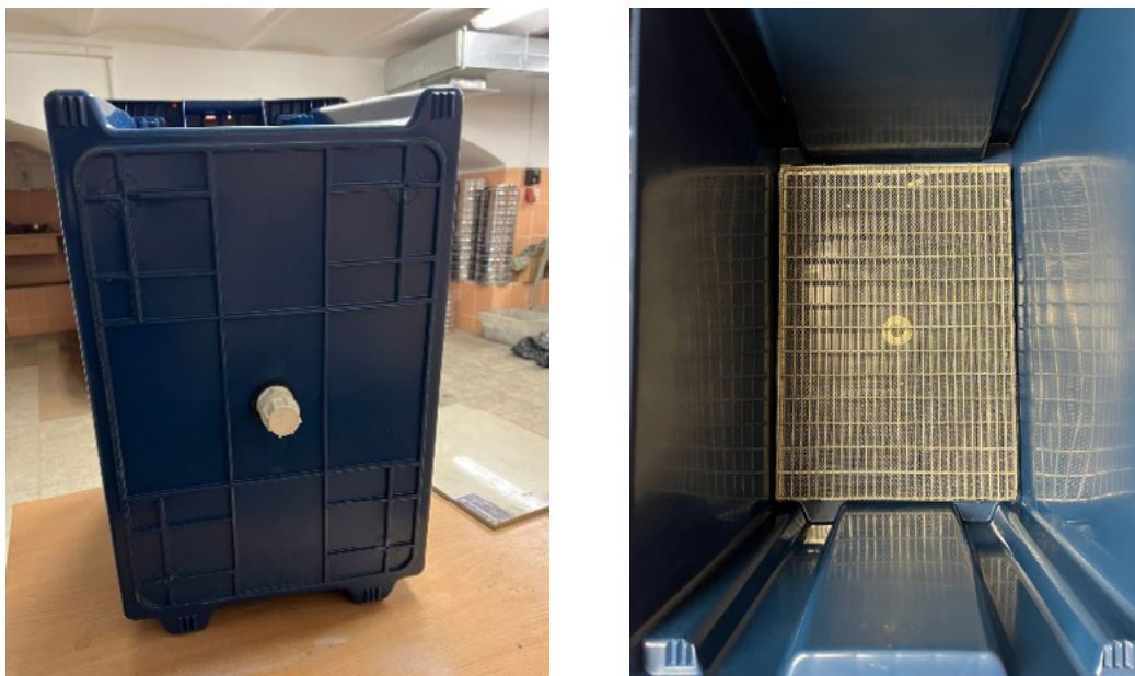
Рис. 6. Бокс с соединителем для перекрытия воды и с оцинкованной решеткой внутри. Автор: И.С. Игошев
