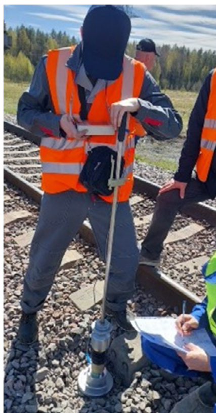
Рис. 1. Измеритель модуля упругости грунтов и оснований дорог ПДУ-МГ4.01 «Удар».
