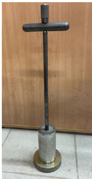
Рис. 7. Ручной уплотнитель грунта с грузом.
