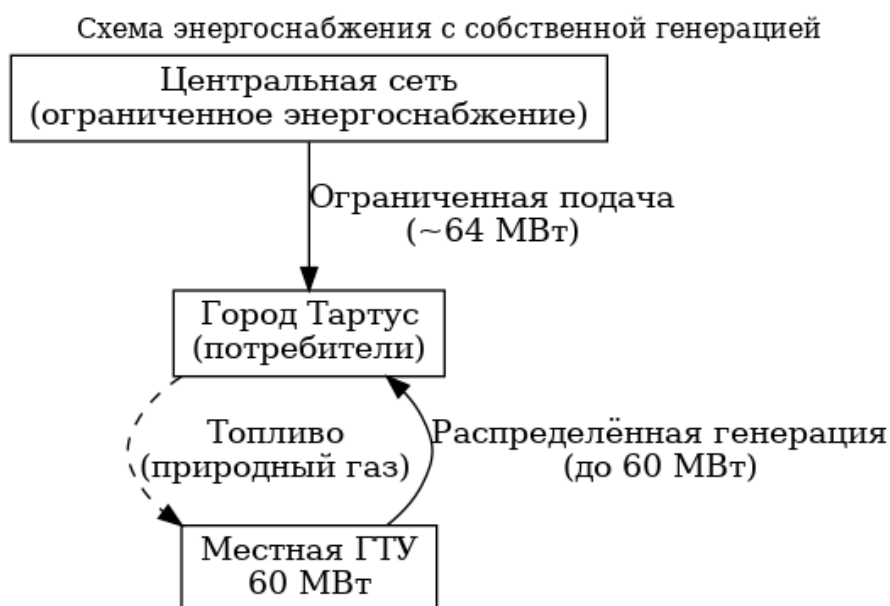
Рис. 1. Схема энергоснабжения с собственной генерацией в г. Тартусе
