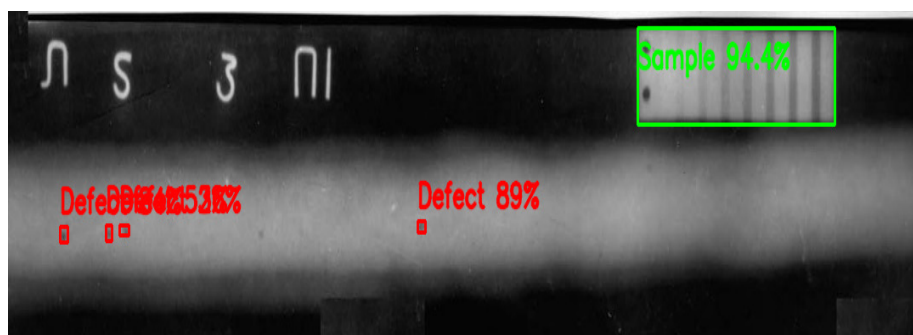
Рис. 9. Пример распознавания небольшого дефекта и ИКИ
